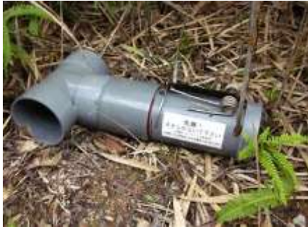
奄美地域で利用されている鳥類の錯誤捕獲を防止するためのアタッチメントを付した筒罠
