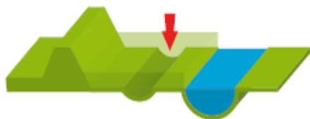
図1) 氾濫原を下げる 氾濫原の一部を低くしたり掘り下げたりすることで水位上昇時の水の場所を確保する
