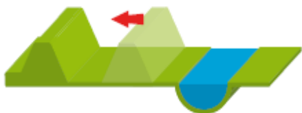
図2) 堤防の移動 堤防を内陸に移動させることで氾濫原が拡がり、川のための場所も増える
