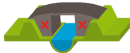
図4) 障害物の撤去 可能であれば障害物を撤去もしくは改めて流量を増やす
