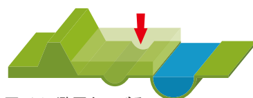
図1) 氾濫原を下げる 氾濫原の一部を低くしたり掘り下げたりすることで水位上昇時の水の流れる場所を確保する。
