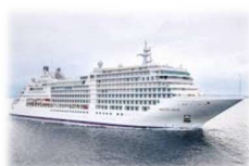
シルバームーン ジャパネットクルーズ 総トン数 40,700t 全長/全幅 212.8m/27m 乗客定員 596人 乗組員数 411人 ラグジュアリークラス
