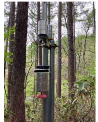
（ICレコーダー設置状況）
