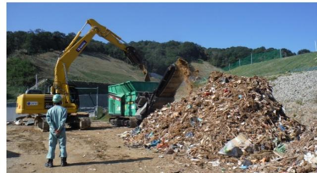
玖谷埋立地内の移動式破砕機
