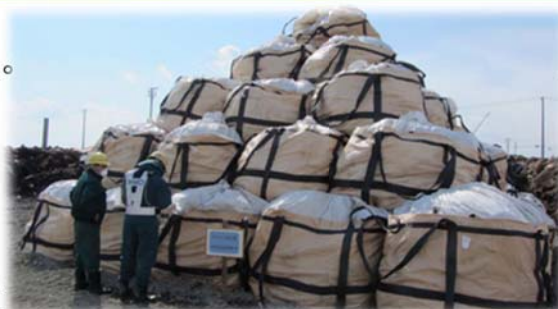
畳をフレコンに詰めて5段積みした実験 → 1週間で60℃に上昇し、直ぐに解体
