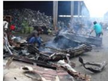
ケーブルの燃焼で煙りが出る様子
