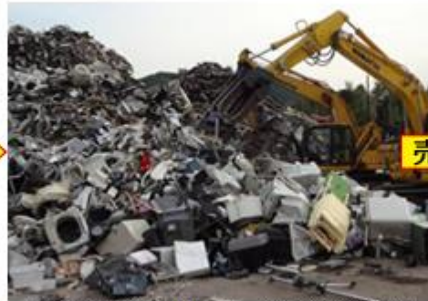
重機で破碎圧縮(フロンや鉛を垂れ流し)
