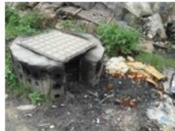
電子機器の基板を焼くストーブ
