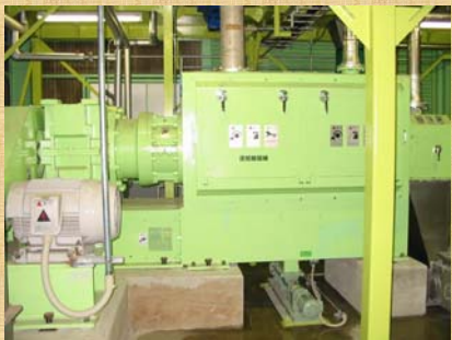
脱脂機 食品衛生法適合率脂肪分18%を6%以下に脱脂
