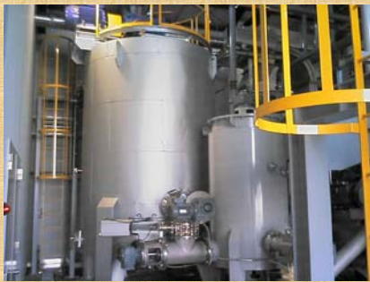
蒸気間接型乾燥機 1時間で含水率12%以下に乾燥
