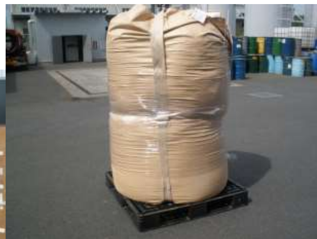
標準型1tフレコンに充填し2袋を重ねラップで固定
