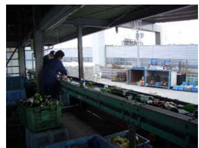
回収されたビンをコンベアにかけて、種類ごとに手作業で分類する。
