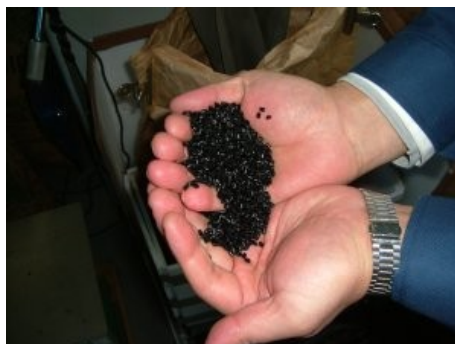
廃プラスチックをペレット化。プラスチックフレーム等としてリサイクルする。
