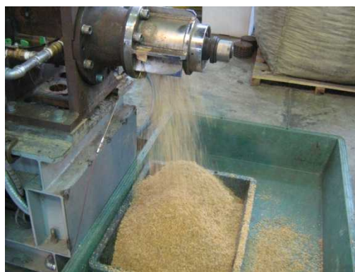
写真 10 籾殻の吸水をよくするために細胞を崩す加工
