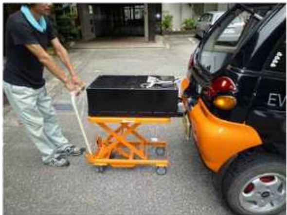
写真 12 専用のジグを使用して EV のバッテリーを交換する様子
