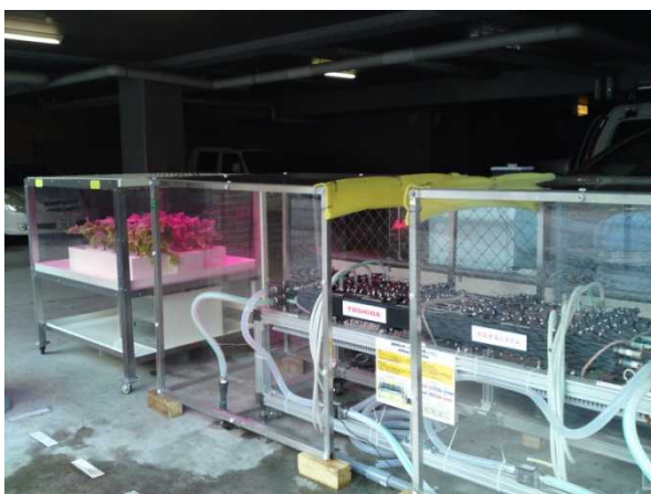
写真8 温度差発電システムと野菜栽培用の照明装置
