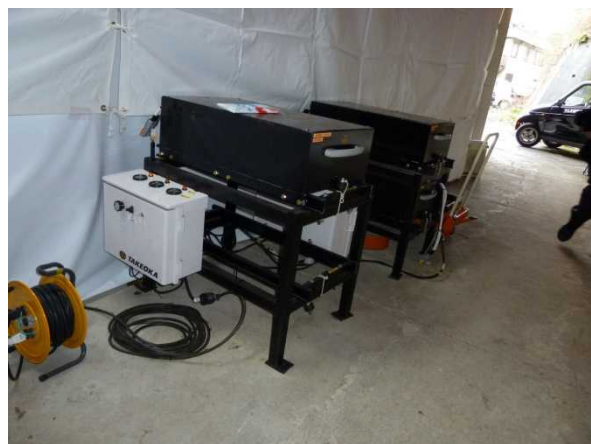
写真 11 EV の着脱式バッテリー用の充電装置
