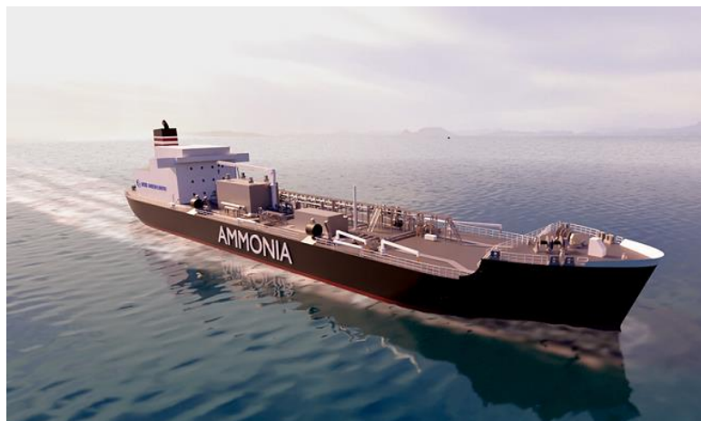
弊社が開発したアンモニアバンカリング船の3Dモデル
